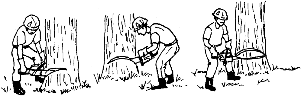
Figura 25. Cuando el largo útil de la barra es menor que el diámetro Fuente: Manual de Motosierras FAO/PER/78/ 003
