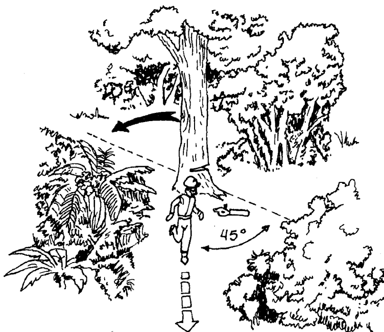
Fig. 22. Construcción de la ruta de escape Fuente: Manual de Motosierras FAO/PER/78/ 003
